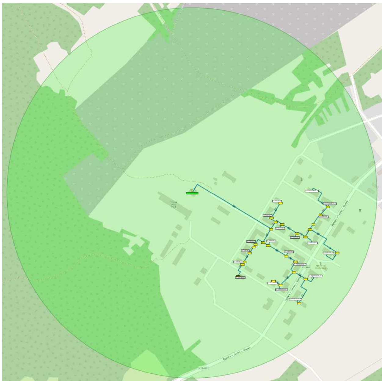
Рисунок 22. Радиус эффективного теплоснабжения котельной п. Тесово-4
